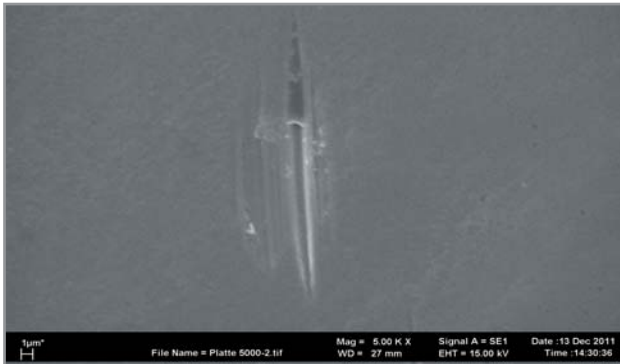
Abb. 16: REM-Aufnahme einer eingeebneten Stelle mit verbliebener „Scharte“, hervorgerufen durch einen Diamantkorn des verwendeten Rotring Diamanten.
