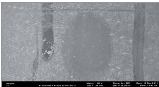
Abb. 14: Das Abrasionsfeld der Steatit-Kugel auf einer eingeschliffenen Probe.
