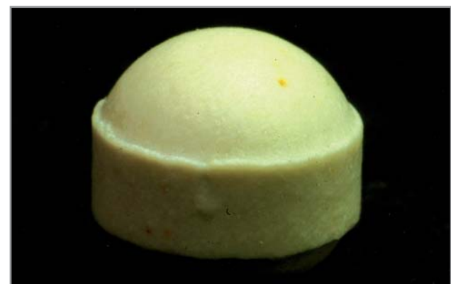
Abb. 7: Raue Steatit-Kugel als Schmelzanalogue.
