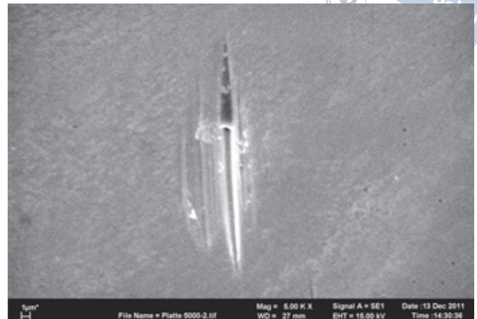
Abb. 17 Eine REM-Aufnahme, 5.000-fach, der vom Steatit-Antagonisten geglätteten Oberfläche. Mittig ist noch eine verbliebene Schleifspur eines Diamantkorns des FG-Diamanten zu erkennen.
