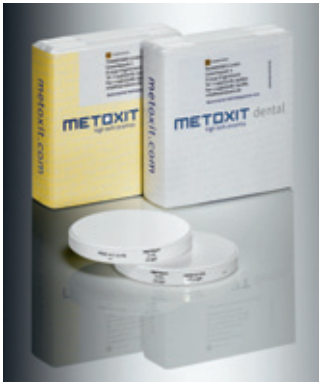
Abb. 8 Das Testmaterial: transluzentes Zirkoniumdioxid der Firma Metoxit AG, Tayngen, Schweiz.
