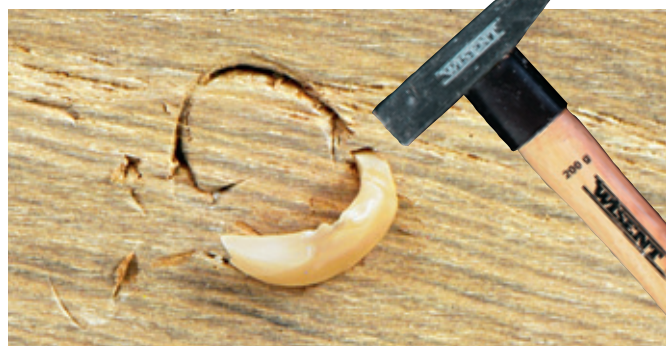
Abb. 36 und 37 Harte deutsche Eiche (Implantatlager) absorbiert die hohe kinetische Energie des Hammers nicht – die Zirkoniumdioxidkrone bricht, aber auch das Lager leidet.
