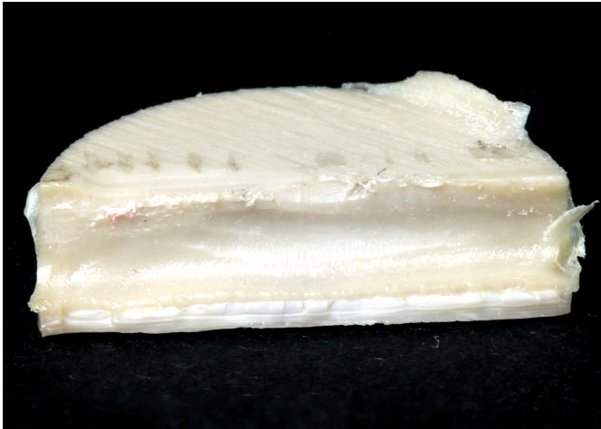
► 10 Unterschiedlich aufgebaute Hochleistungspolymere zeigen ein unterschiedliches Bruchverhalten. Die hier abgebildete Bruchstelle eines reinen PEEK nach zirka zehn Biegewechselsn zeigt das typische Bruchbild eines plasto-elastischen Materials – die weiße Bruch-Naht. Bei anderen Polymeren sieht und hört man ein glasartiges Brechen.
