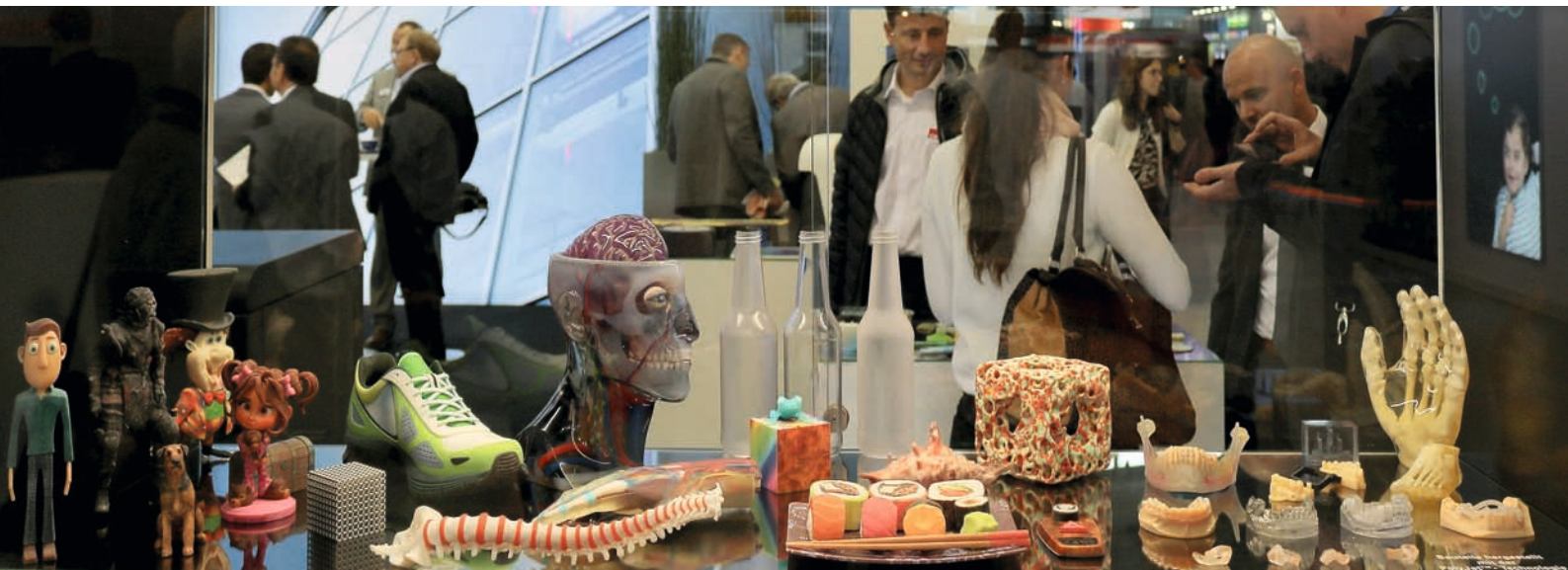
▣4 Durch den Einsatz von mehreren Düsen können im Inkjet-Verfahren mehrfarbige Gegenstände gedruckt werden
