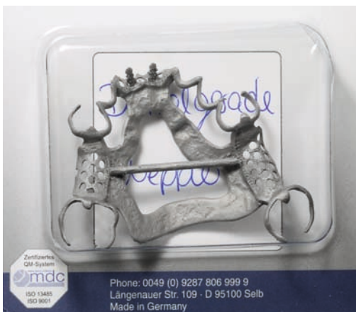
17 Die konsequente Herstellung digitaler Modelgüsse – das SLM Verfahren (Arbeit gefertigt von LAC Center/selb). So kommt der Modellguss ins Haus, sauber und sicher verpackt – nach vorschriftsmäßigem Entspannungsglühen, für optimale Materialeigenschaften.
