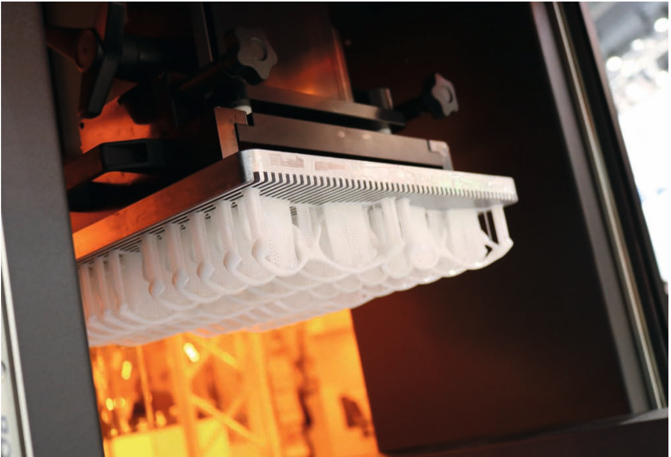
02 Das DLP-Verfahren härtet Photopolymere durch Licht (LED)
