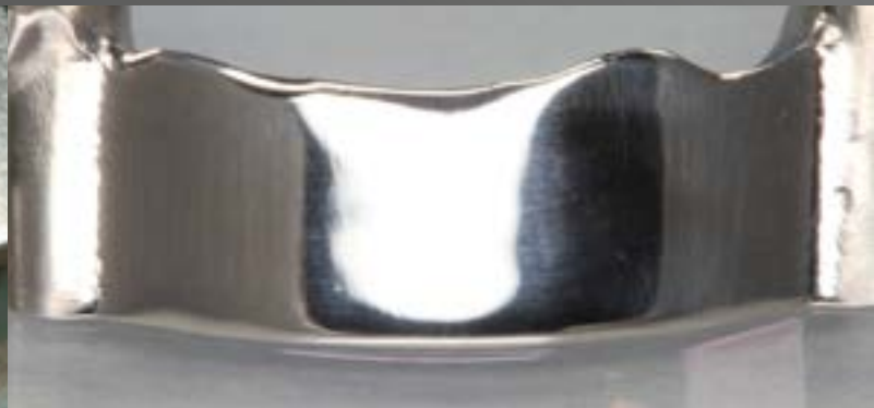
04 Polierte Oberfläche eines konventionell gegossenen und anschließend gefrästen Steges mit homogener Oberfläche
