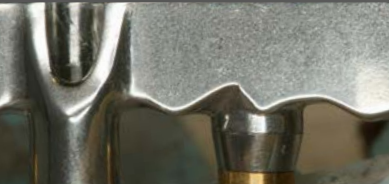
03 Polierte Oberfläche eines gefrästen Green Metal-Steges mit „grieseliger“ Oberfläche
