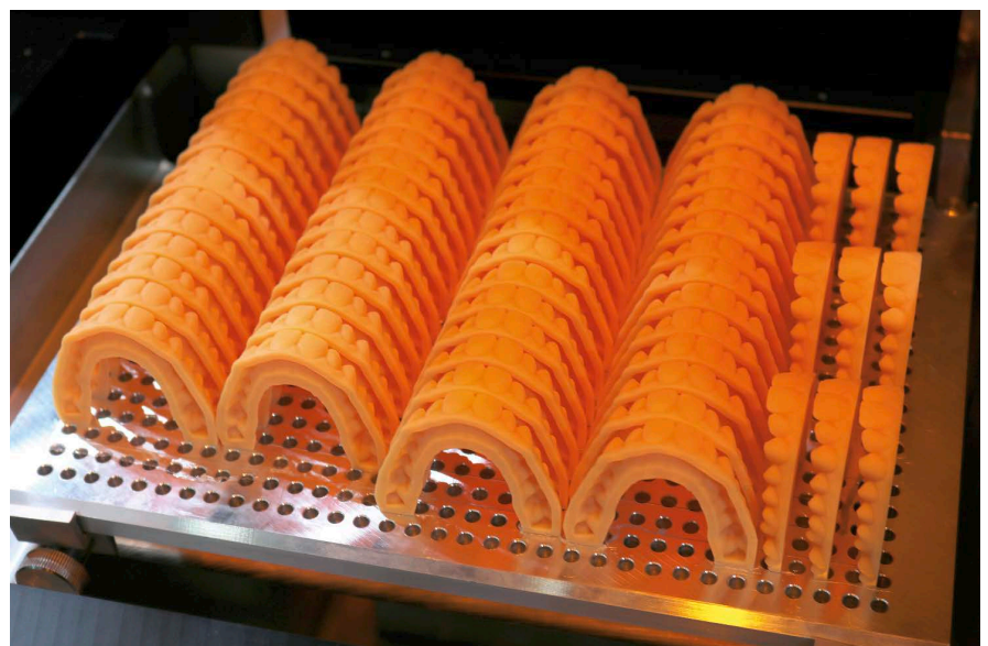
▷ 12 Ein Teil der Zukunft – die Umsetzung von STL-Files aus IO-Scanner in physische Modelle im Envision Tec Drucker
