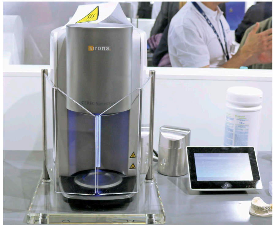
▷ 8 In 15 Minuten zur gesinterten Krone. Chairside Sinterofen von Sirona.
