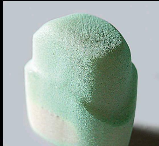
► 12 Sprays tragen unterschiedlich dick auf
