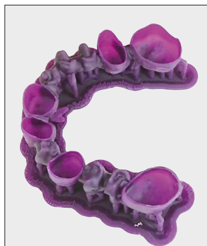
Das Gerüst – mit 3D-Druck hergestellt und bereit zum Gießen
